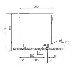
Electrical inlet (power) Equipotential screw
